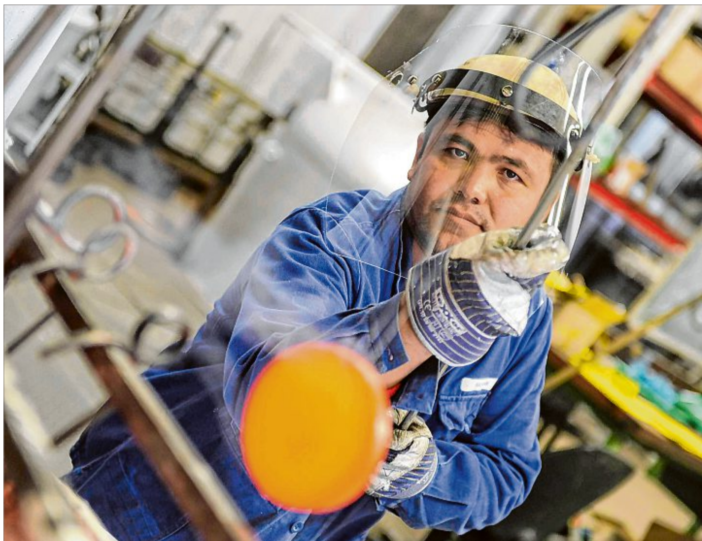
Ein SWF-Mitarbeiter setzt ein Werkstück, mit besonderen Anforderungen an die Härting, aus der Salzschnmelze um.
