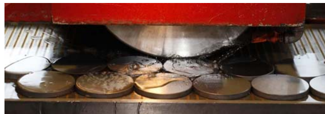
Erzeugung des Oberflächen-Finish von Härtevergleichsplatten.
