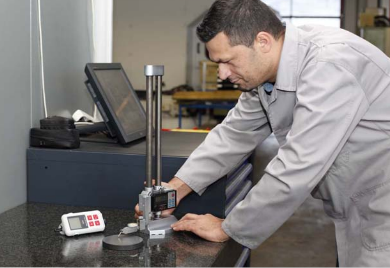
Qualitätsprüfung einer Härtevergleichsplatte im Fertigungsablauf bei SWF in Siegen.
